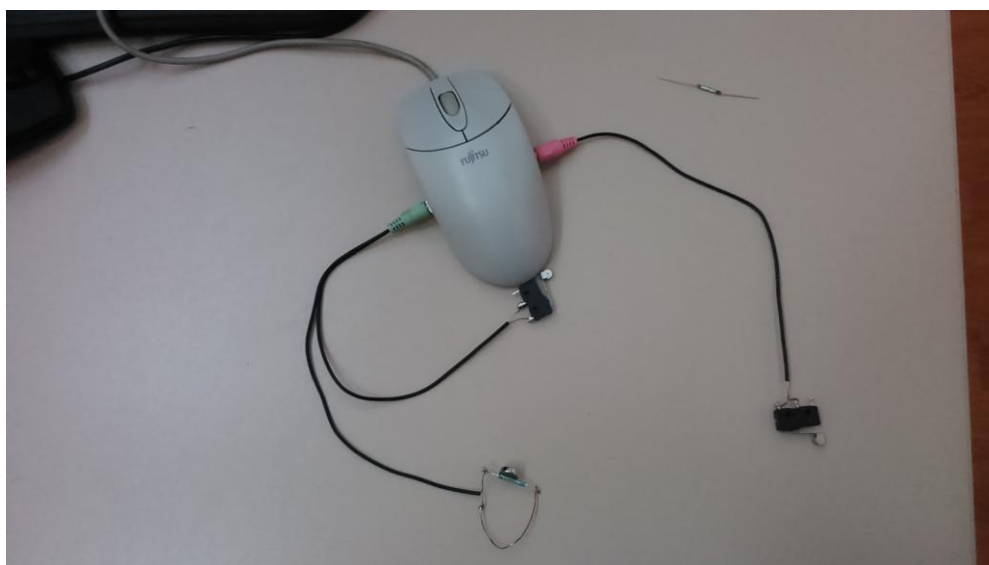
Conexión de distintos tipos de pulsadores al ratón.
