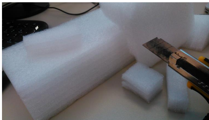
Recortado de la espuma para dar forma al pulsador.
