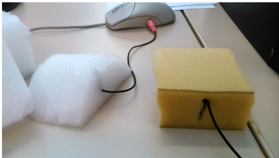
Conexión del pulsador al ratón.
