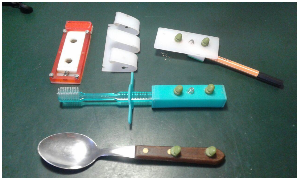
De izquierda a derecha y de arriba abajo: Dispositivo de encastre, adaptación para férula, accesorio para escritura, accesorio para cepillo de dientes, cuchara adaptada.
