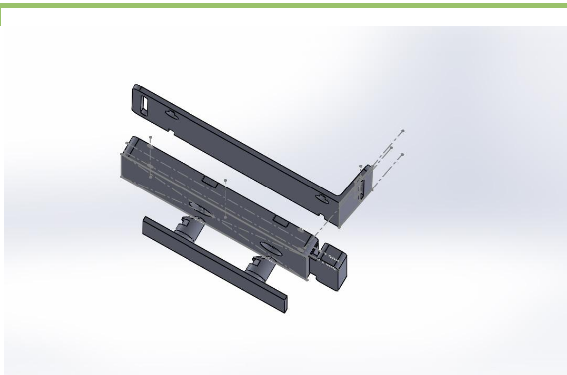
Imagen de SolidWorks. Se muestra el dispositivo al centro, arriba el accesorio para uso sin férula de muñeca, y debajo el encastre.
