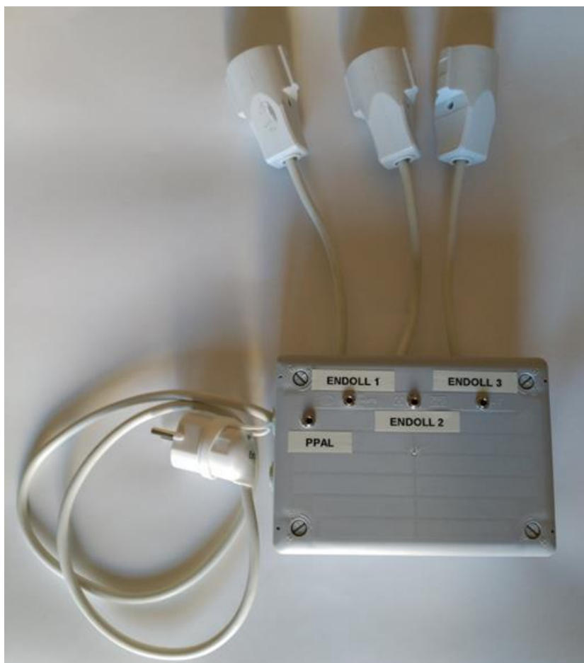
Caja de conexión de bajo coste, para accionar diferentes dispositivos eléctricos (220V) a partir de pulsadores (corriente continua).
