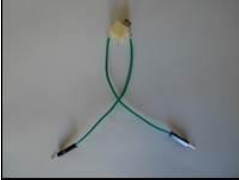
Conexión de los cables Dupont al Jack hembra mono de 3,5 mm
