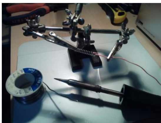
Soldando el muelle y el cable con un soporte para soldadura.
