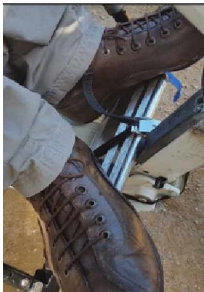
Imagen del reposapiés fijado al adaptador y, consecuentemente, al patinete con una correa con hebilla de seguridad.
