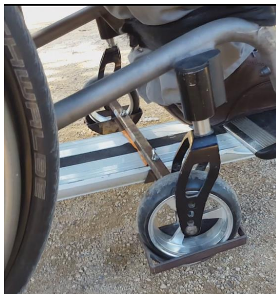
Imagen del acople de las ruedas delanteras en el adaptador PATI 1.
