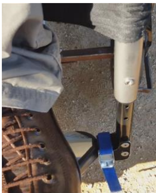
Imagen de correa con hebilla que evita que el reposapiés fijo se levante.
