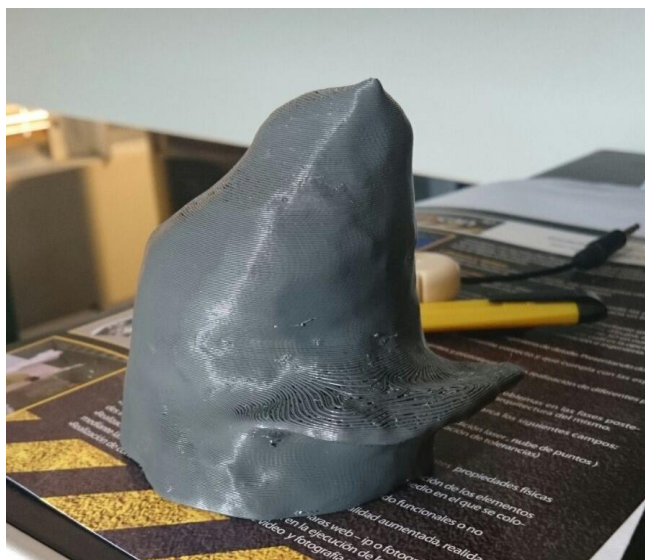
Joystick elaborado en polímero en impresora 3D (en proceso).
