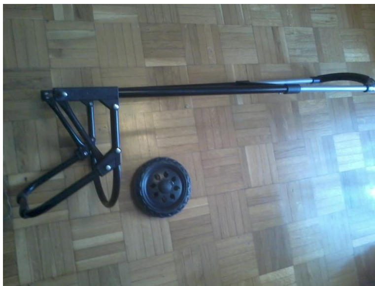
Estructura del carrito sin adaptar, a la que se quitado su rueda principal
