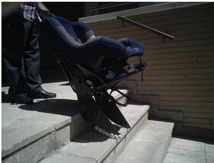
Carrito con los patines-rueda salvaescaleras inclinados y apoyados en la huella del peldaño.
