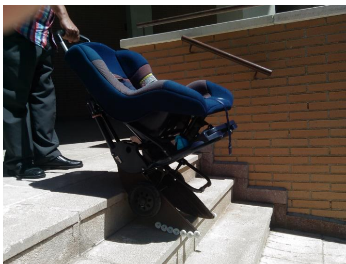
Carrito con los patines-rueda salvaescaleras algo menos inclinados, y su rueda principal flotante.
