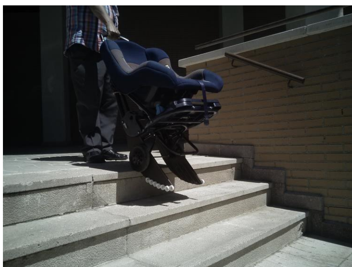
Carrito con los patines-rueda salvaescaleras inclinados, al estar las ruedas principales en el borde del peldaño.
