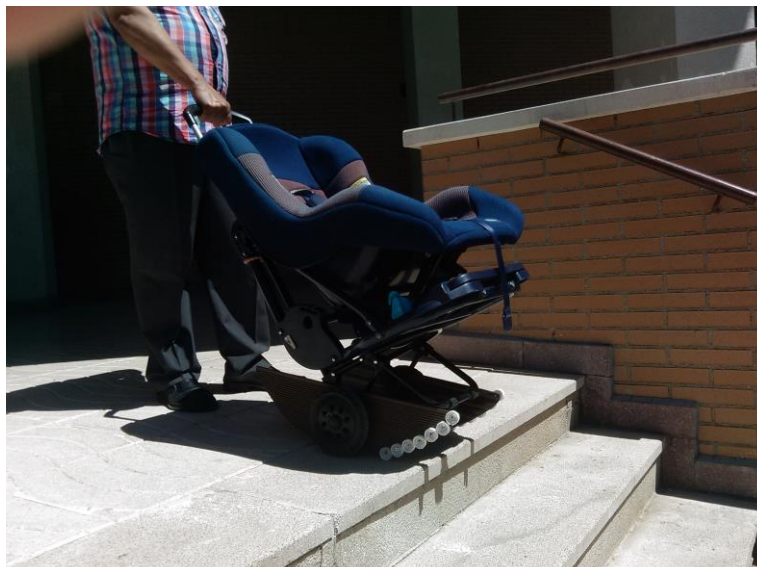
Carrito adaptado con los patines-rueda salvaescaleras, en su posición de equilibrio o en llano.
