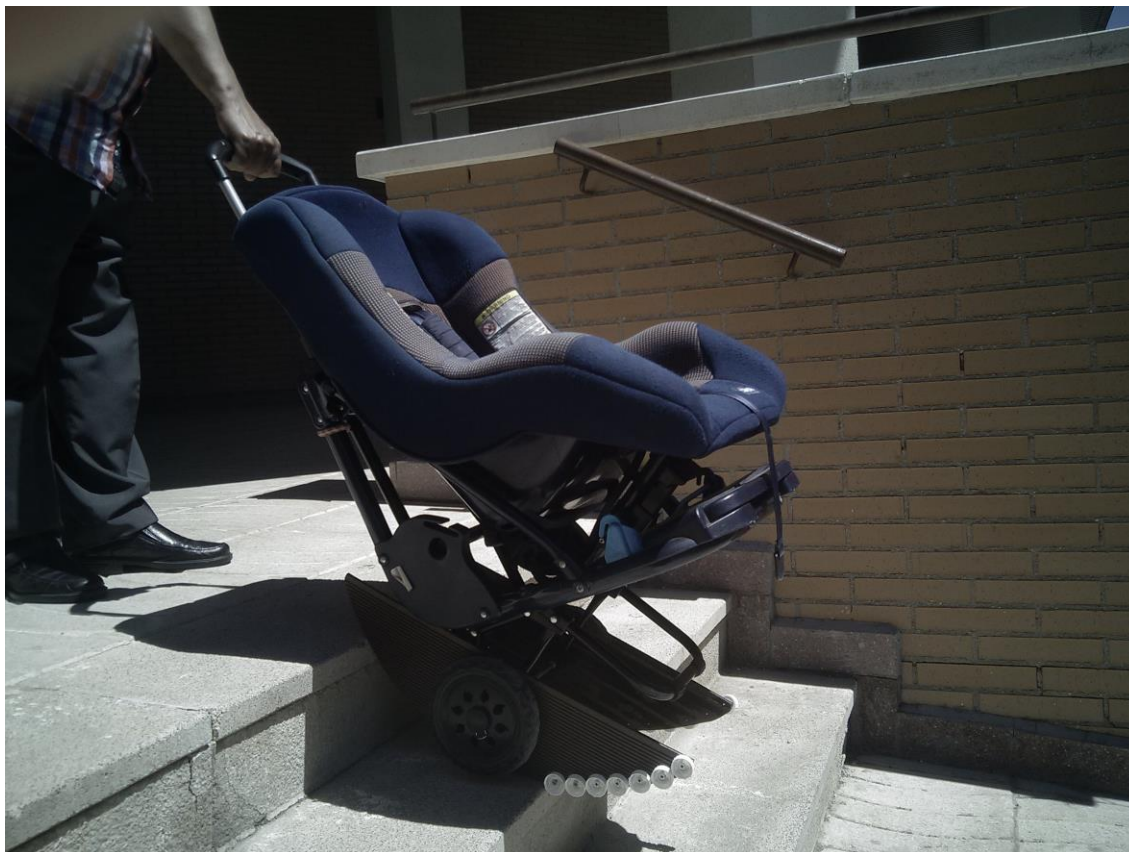
Carrito con los patines-rueda salvaescaleras casi en su posición de equilibrio, con su rueda principal apoyada en la huella del peldaño.
